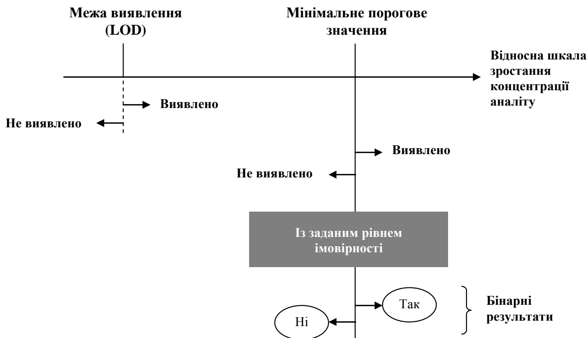
Рис. D2. Два кількісні параметри, з якими пов'язаний бінарний результат кваліфікаційного/класифікаційного якісного аналізу: 1. Межа виявлення (LOD), властива даному методу. 2. Мінімальне порогове значення, зазначене у документі на методику. Вони показані на уявній шкалі зростання концентрації. Мінімальне порогове значення, яке лежить у зоні виявлення вище межі виявлення, дає змогу виділити зони концентрації компонента, у яких буде отримано правильний бінарний результат, тобто "ні" для значень, нижчих за межі та "так" – для значень, вищих за межі.
